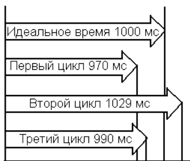
Рис. 3. Расчет разброса в допустимом интервале \pm 30 мс
