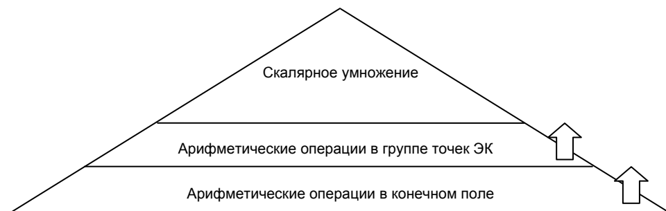
Рис. 3. Обобщенная иерархия операций при скалярном умножении в группе точек эллиптической кривой
