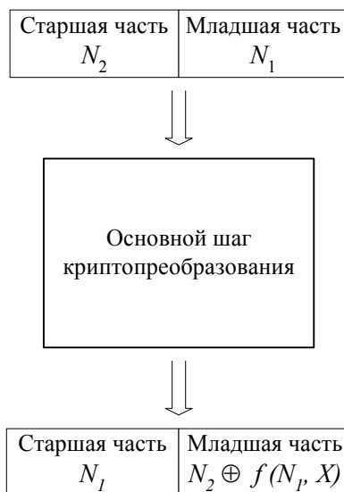
Рис. 7. Содержание основного шага криптопреобразования для блочных шифров, подобных ГОСТу
