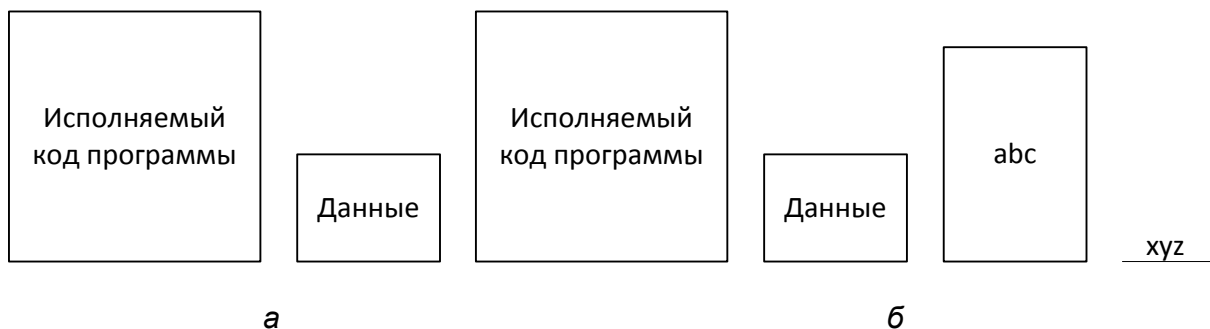
Рис. 3. Сегментированный процесс до отображения файлов на адресное пространство (а); процесс после отображения существующего файла abc на один сегмент и создания нового сегмента для файла хуз (б)
