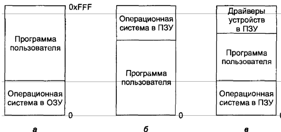
Рис. 1. Три простейшие модели организации памяти при наличии ОС и одного пользовательского процесса. Существуют также и другие возможные варианты
