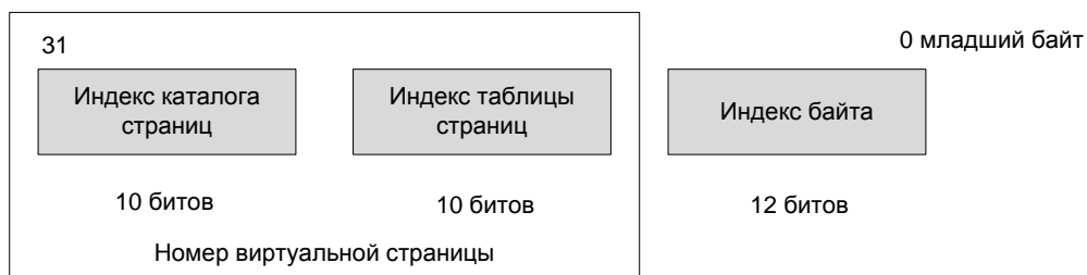
Рис. 9. Элементы 32-разрядного виртуального адреса в x86-системах
